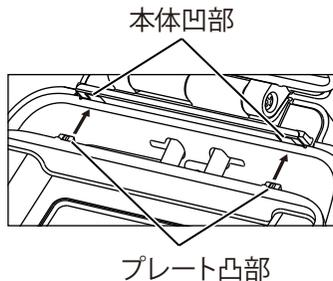
②本体をおさえながらプレートを矢印の方向にカチッと音がするまで押し込み、取り付けます。
