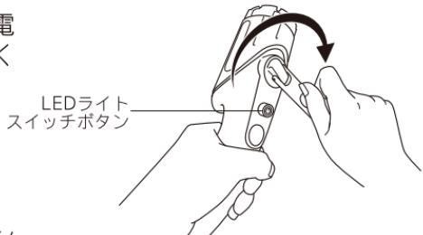
2. LEDライト用スイッチボタンを押すとLEDライトが点灯します。もう一度スイッチボタンを押すと消灯します。
